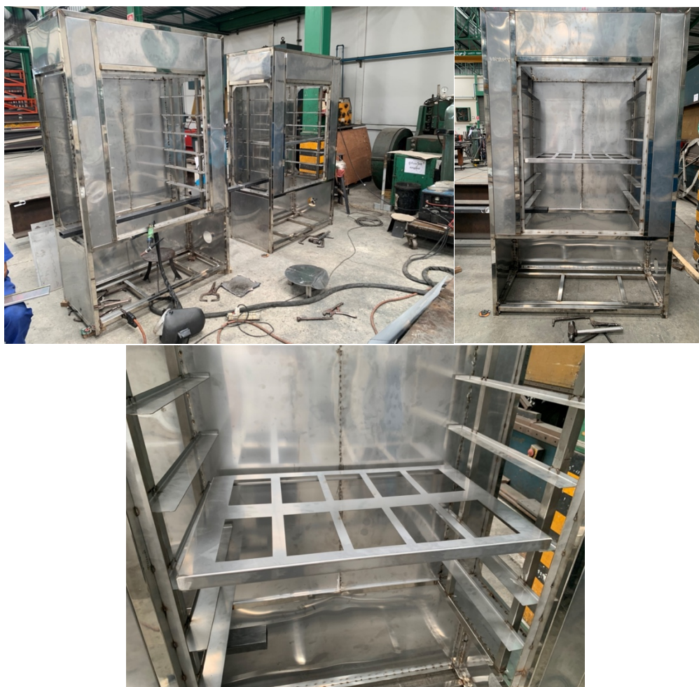
รูปที่ 4.12 การสร้างและประกอบตู้รมก๊าซโอโซน
