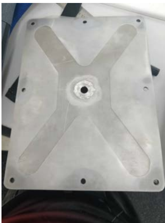
รูปที่ 4.31 การใช้ซิลิโคนปิดรอยรั่วบริเวณภายในหัวฉีดก๊าซไอโซน
