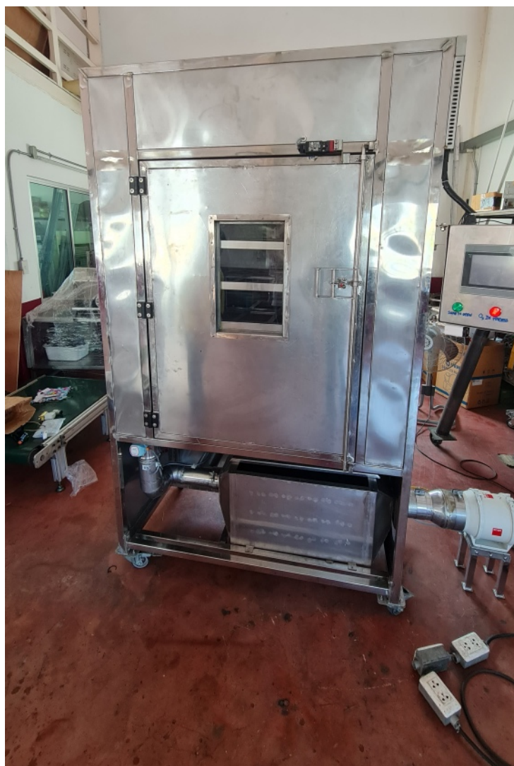
รูปที่ 4.25 ตำแหน่งการติดตั้งอุปกรณ์บำบัดก๊าซไอโซนเหลือจ่ายส่วนล่างของตู้รมก๊าซไอโซน
