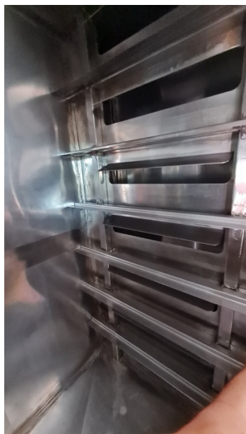
ก) ช่องทางลมเข้า (ขวา) แสดงช่องเปิดเพื่อให้ลมเข้า
