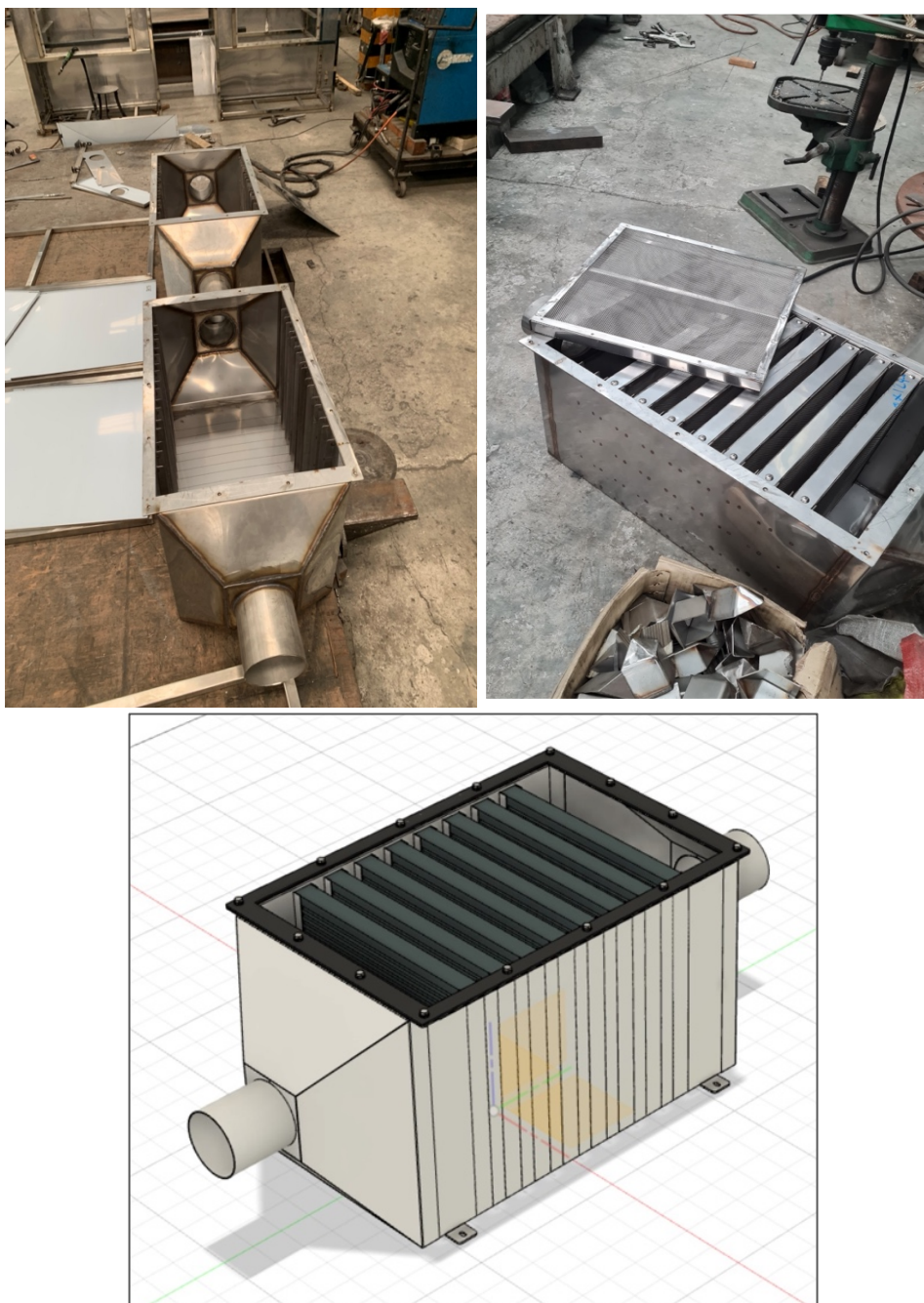
รูปที่ 4.24 การขึ้นรูปอุปกรณ์กำจัดโอโซนเหลือจ่าย
