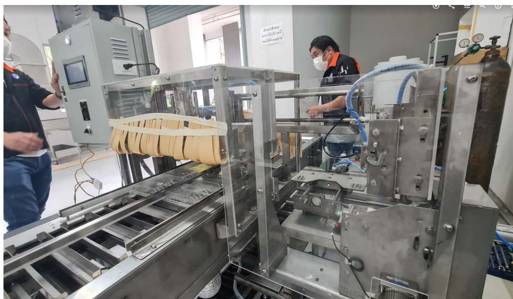
รูปที่ 4.49 เครื่องฉีดก๊าซโอโซนกึ่งอัตโนมัติเมื่อประกอบแล้วเสร็จ ติดตั้ง ณ มหาวิทยาลัยเทคโนโลยีพระจอมเกล้าธนบุรี
