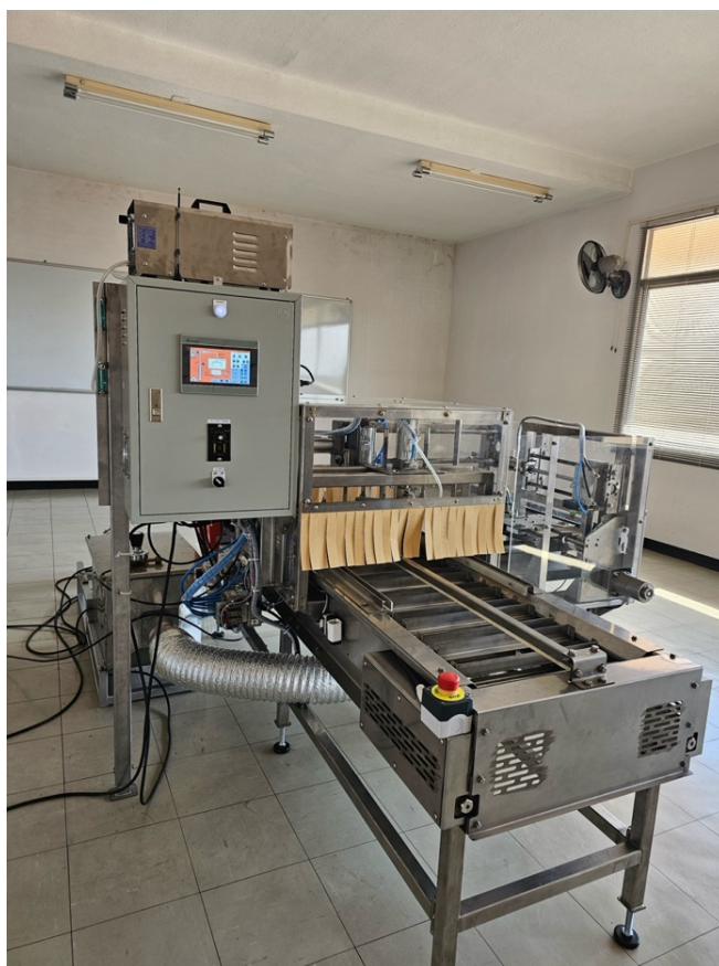
รูปที่ 4.48 เครื่องฉีดก๊าซโอโซนกึ่งอัตโนมัติเมื่อประกอบแล้วเสร็จ ติดตั้ง ณ มหาวิทยาลัยแม่โจ้
