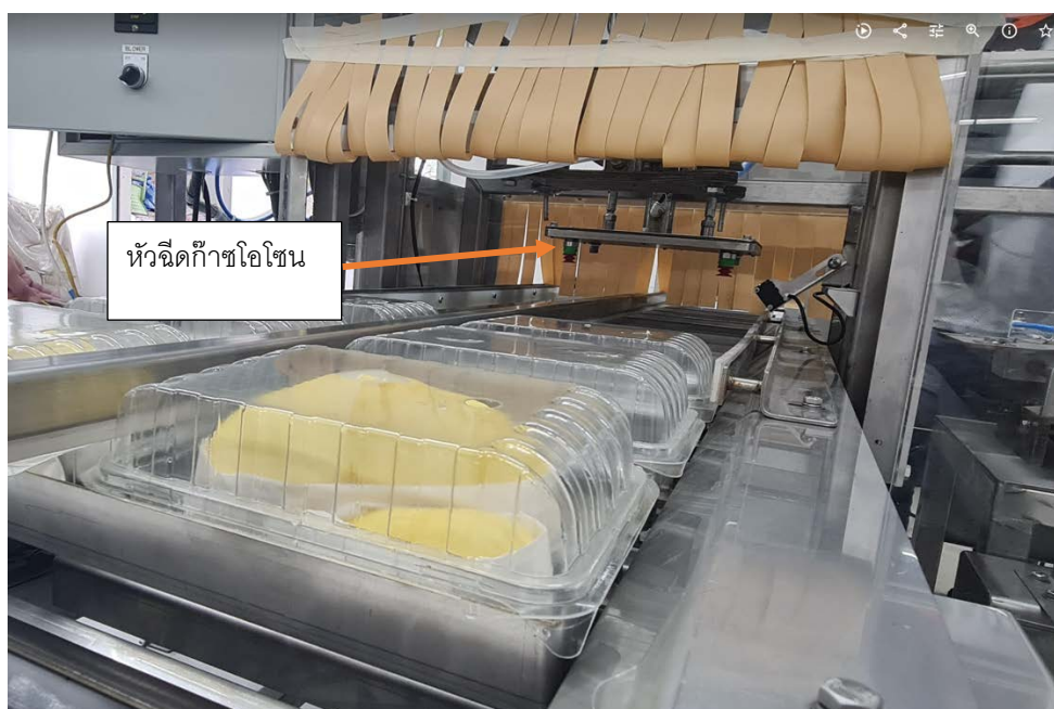
รูปที่ 4.35 การปรับตั้ง Alignment ของหัวฉีดไอโซนให้ขึ้นลงในแนวดิ่ง ตรงกับรูป้อนก๊าซบนกล่องบรรจุ
