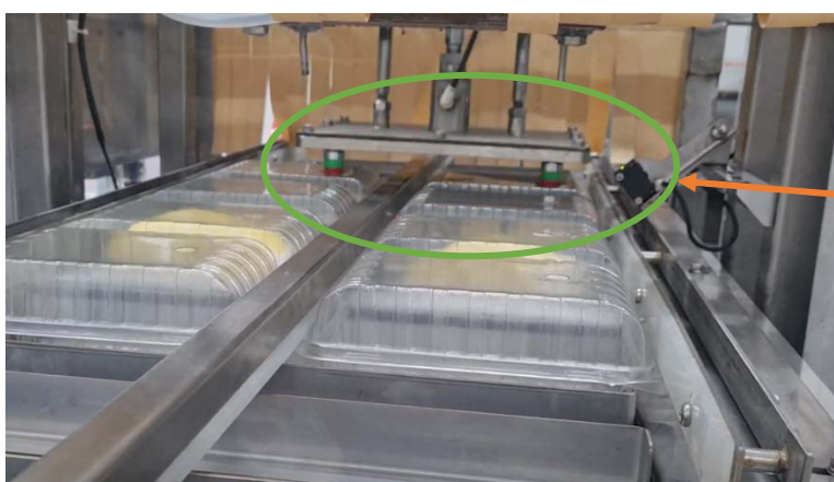
รูปที่ 4.36 ขั้นตอนการติดสติ๊กเกอร์บนกล่องเพื่อป้องกันก๊าซโอโซนรั่วไหลออกจากกล่องบรรจุทุเรียน
