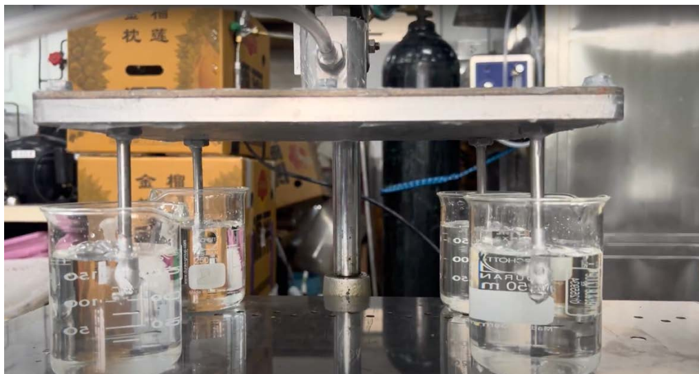
รูปที่ 4.29 การทดสอบการกระจายตัวของก๊าซออกซิเจนที่หัวฉีดผ่านน้ำ
