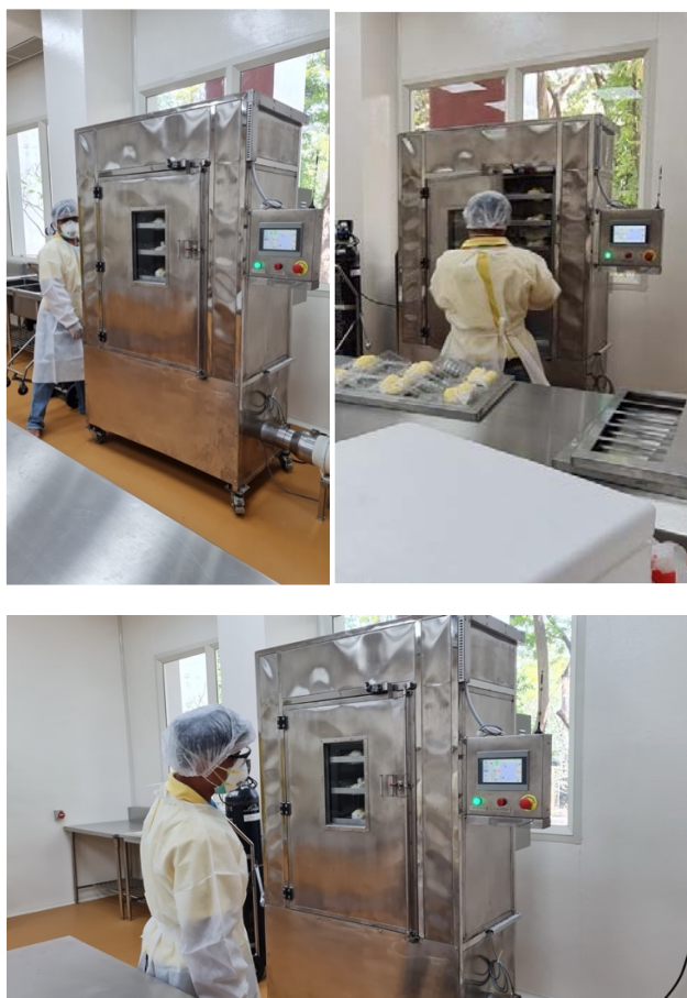
รูปที่ 4.15 ตู้รมก๊าซไอโซนสำหรับทุเรียนตัดแต่งพร้อมบริโภคมือประกอบและสร้างแล้วเสร็จ
