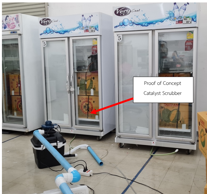
รูปที่ 4.22 Proof of Concept อุปกรณ์บำบัดก๊าซไอโซนเหลือจ่าย
