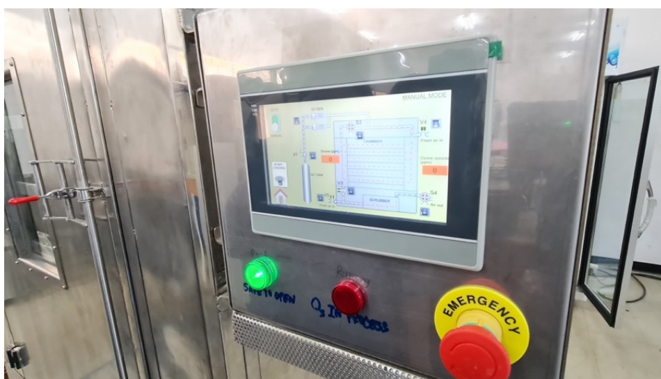
รูปที่ 4.19 จอสัมผัส HMI ควบคุม PLC สำหรับการประมวลผลการทำงานของระบบกำเนิดก๊าซโอโซน
