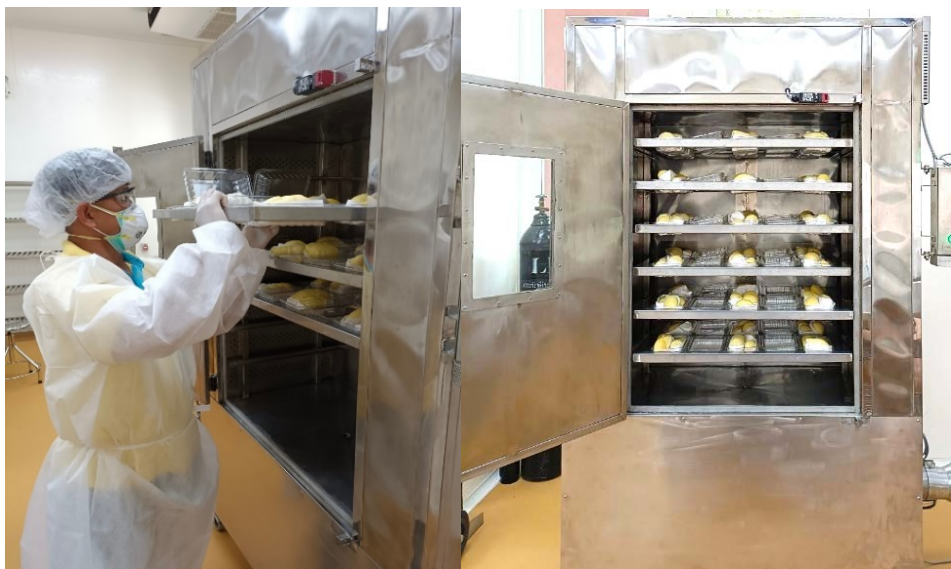
รูปที่ 3.7 ลักษณะการจัดเรียงกล่องตัวอย่างทุเรียนภายในตูรมีก๊าซโอโซนแบบถาด (โมเดล 1)
