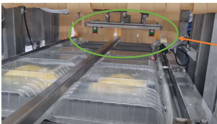
2. ชุดติดสติ๊กเกอร์ เคลื่อนไปดูดสติ๊กเกอร์และกลับมาเตรียมพร้อมการติดผนึก
